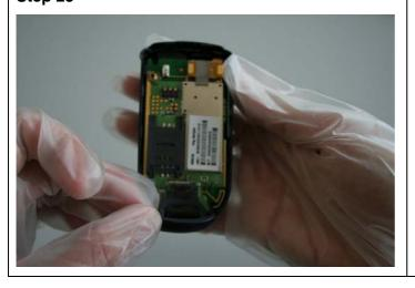
Assemble the MMI Slot Cap.
