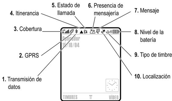
**1. Indicador de transmisión de datos:** muestra el estado de la conexión y de la transmisión de datos. El indicador de conexión inalámbrica Bluetooth® (📶) indica cuándo está activa una conexión Bluetooth. Otros indicadores pueden ser, entre otros:
