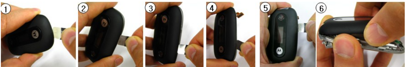
13. 拆下 LCD 固定架:
