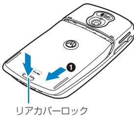
②電池パックの両端のツメを持って矢印①の方向に持ち上げ、矢印②の方向に取り外す
