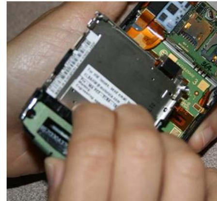
Com os dedos, remover a caixa acústica soltando-a da trava central do shield de magnésio
