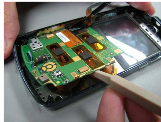
Retirar o cabo TNLC de cima do cabo B2B e com o bege stick 3 mm levantar a placa filha até que o
