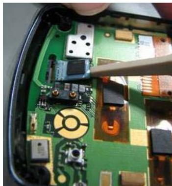
Posicionar o bege stick 3 mm entre o terminal flexível do chassis e placa mãe. Fazer uma alavanca para cima para deslocar o adesivo da placa
