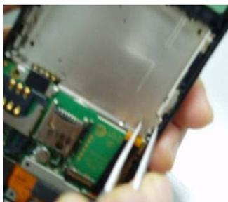
Com a pinça metálica soltar a 1ª trava do chassis que está presa
