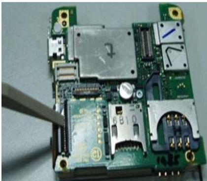
Remover a fita kapton do conector ZIF e em seguida soltar a trava do conector
